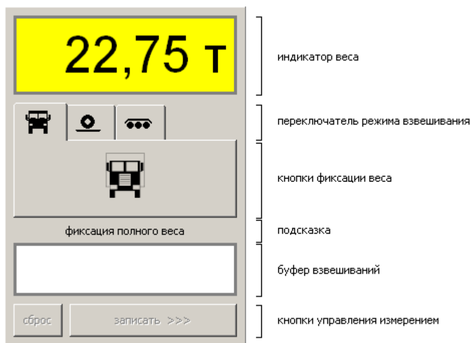
Рис 1. Панель измерения веса. Индикатор веса отображает текущее состояние весов (см. таблицу 1).
